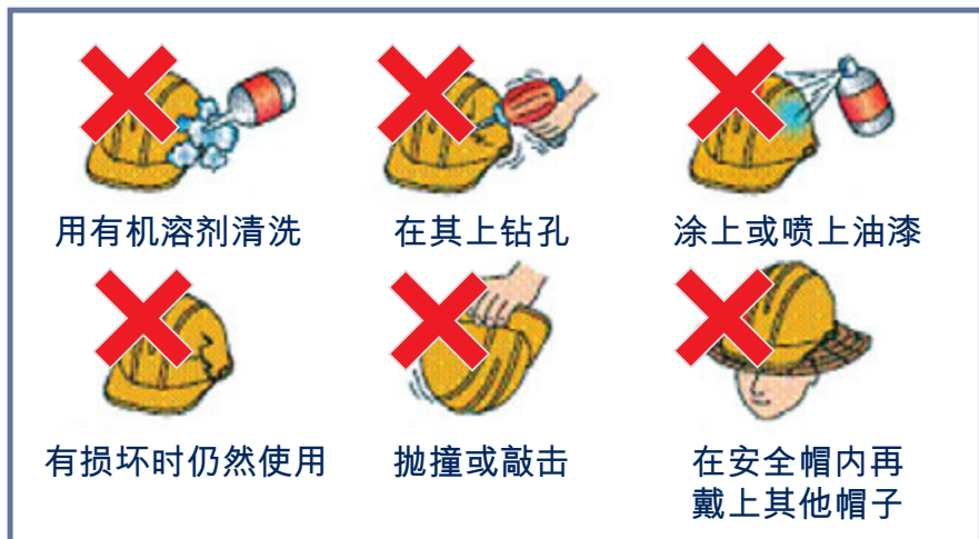
图1-10：个人防护装备—— 安全帽的不正确使用
