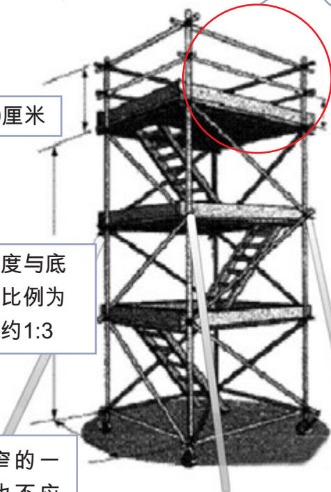
图2-4：应该 供稳固的钢架作上下通道
