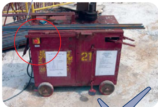
◀ 图6-2：钢筋屈曲 机 / 剪铁机要有 停机掣
