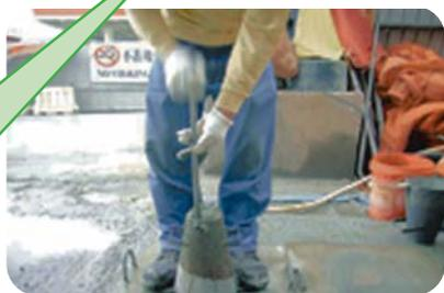
▼ 进行混凝土试件测试，以确认其强度
