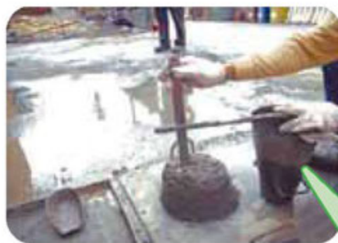
▲ 进行塌落度测试，量度混凝土的和易性 ▶
